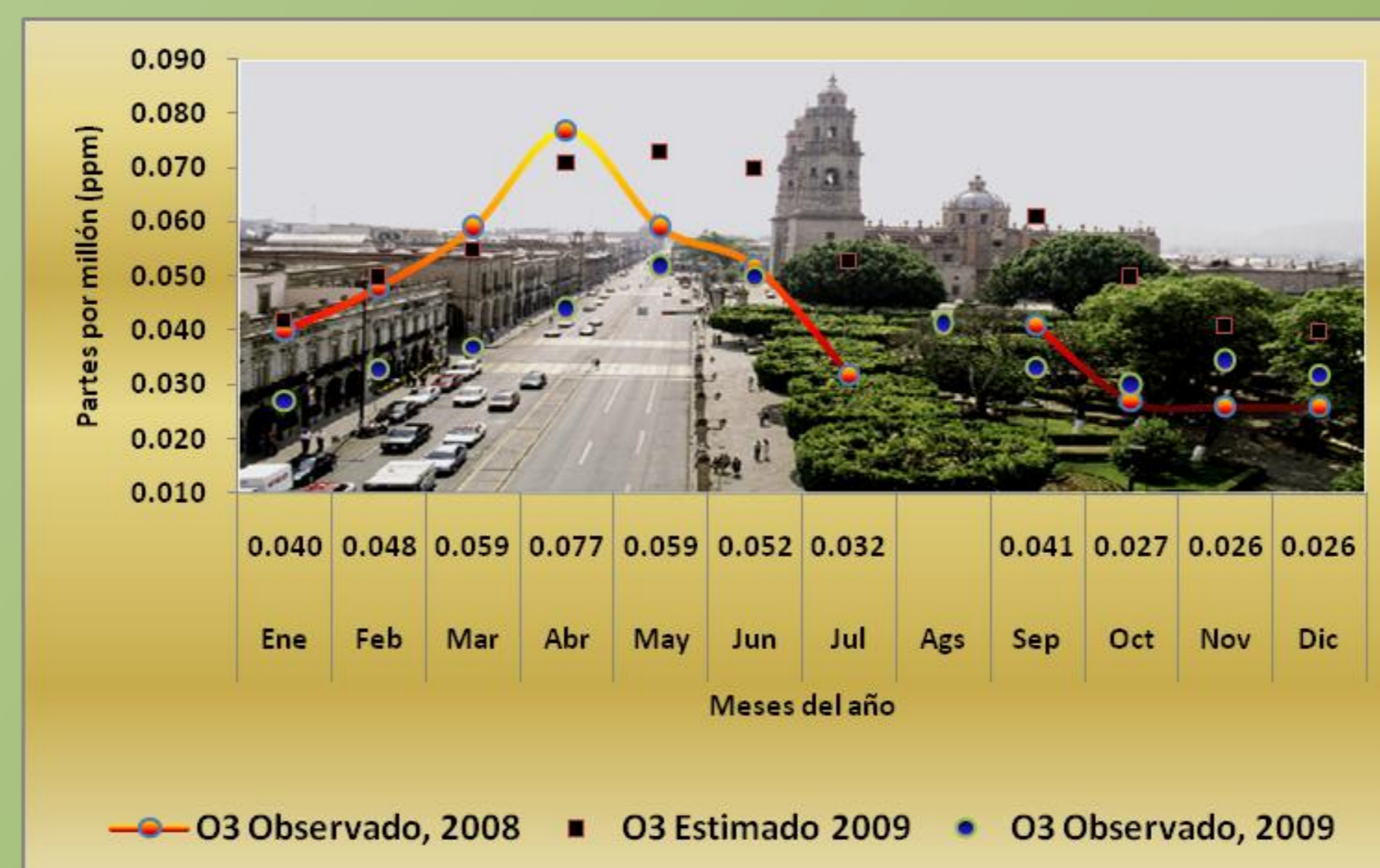
Figura 2. Proyección del promedio mensual de O 3 para el año 2009, comparado con los valores obtenidos por la caseta de monitoreo en el mismo año.
