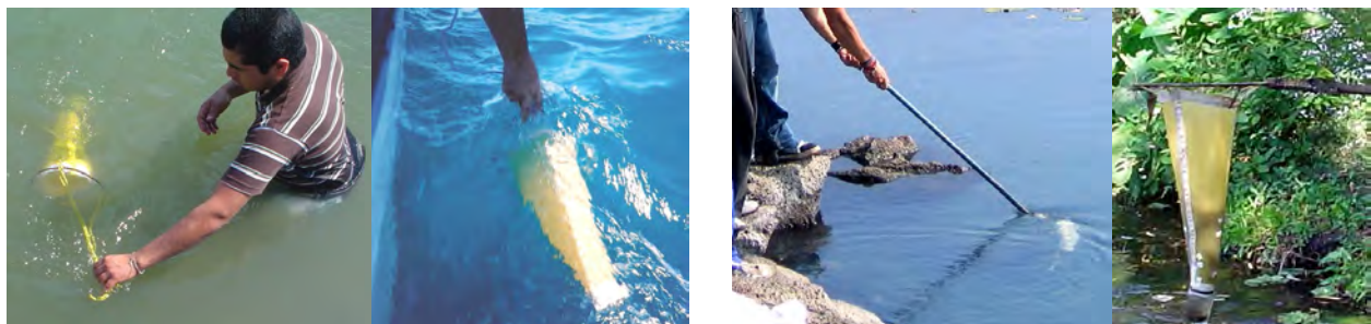
Figura 133. Muestreo por arrastre en sistemas someros, izquierda con red cónica de arrastre y derecha con red de cuchara.
