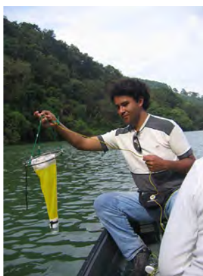
Figura 118. Muestreo de red para análisis cualitativo, colecta en la columna del agua de un cuerpo de agua profundo.
