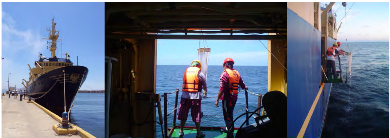
Figura 131. Muestreo de plancton marino por arrastre vertical en la provincia oceánica, a la izquierda se muestra el B/O El Puma de la UNAM y al centro y derecha el winche y la red cónica de arrastre.
