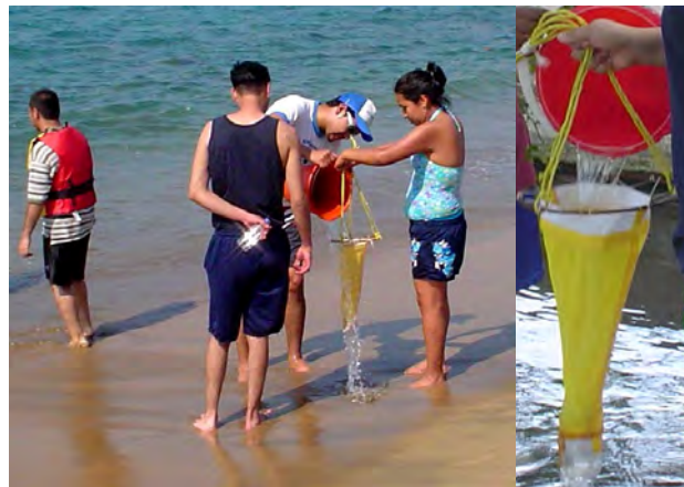
Figura 132. Muestreo estacionario, red cónica para arrastre con una longitud aproximada de 50 cm, aro mayor de 25 cm y una abertura de malla más o menos de 39 \mu m.
