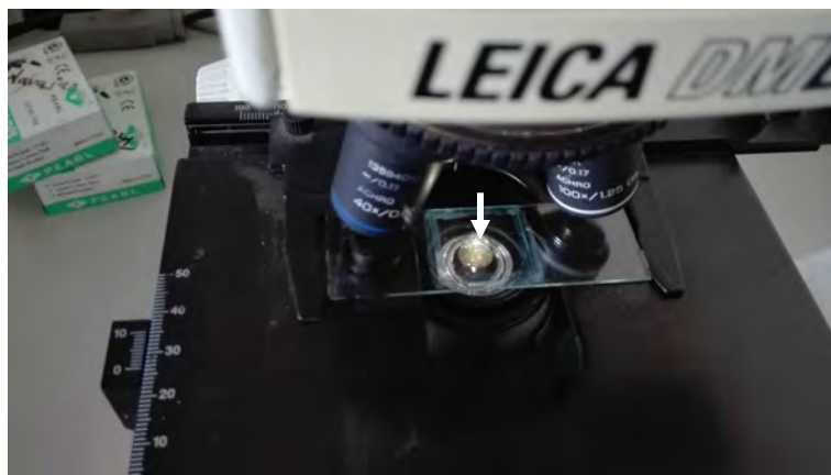
Figura 103. Haz de luz para colocar microgota de aceite de inmersión
