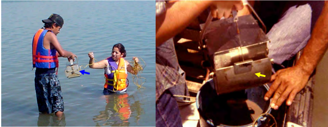
Figura 143. Obtención de sedimentos blandos de zonas menores a tres metros de profundidad por medio de una draga tipo Ekman.
