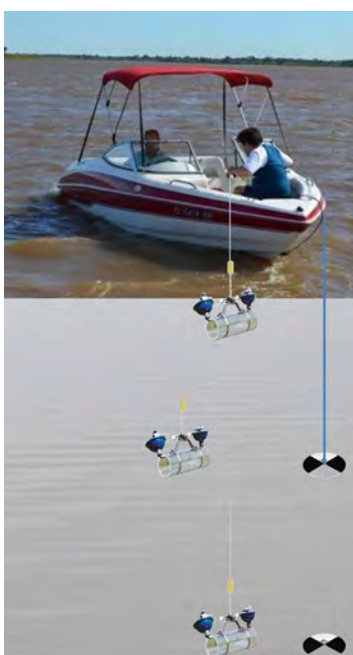
Figura 121. Muestreo para análisis cuantitativo de plancton mediante botella tipo Van Dorn, a diferentes profundidades de la columna de agua.
