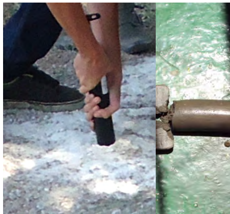
Figura 142. Izquierda obtención de núcleo, derecha barra de núcleo
