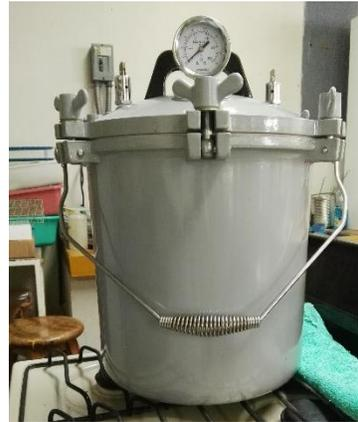
**Figura 2.** El tipo olla de presión es el más común, es un aparato para agua hirviendo a presión. Tiene una cámara vertical de metal provista de una tapa metálica fuerte que se aprieta y cierra herméticamente mediante un aro de goma. Se disponen en la tapa una espita para la salida del aire y el vapor, un indicador de presión y una válvula de seguridad. El agua del fondo de la autoclave se calienta mediante mecheros de gas exterior, un calentador eléctrico de inmersión o un serpentín de vapor.
