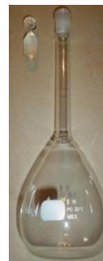
Figura 11. Matraz utilizado para la densidad real del suelo.
