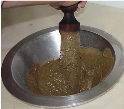
Figura 13. Pasta de saturación del suelo.
