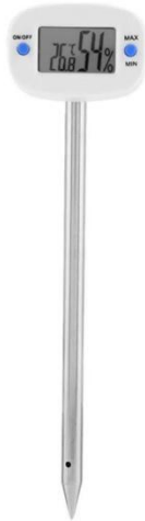
Termo- higrómetro digital edáfico
