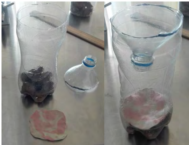
Figura 12. Rellenado de la base del pluviómetro de campo.
