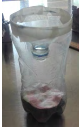
Figura 13. Sellado del embudo sobre la base del pluviómetro de campo.
