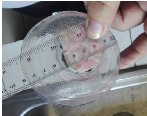
Figura 15. Diámetro de la boca ancha de la base del pluviómetro de campo.
