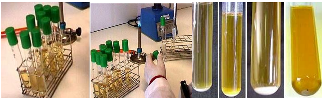
Figura 43. Difusión en agar y diluciones en tubo para probar la eficacia de los productos antimicrobianos.
