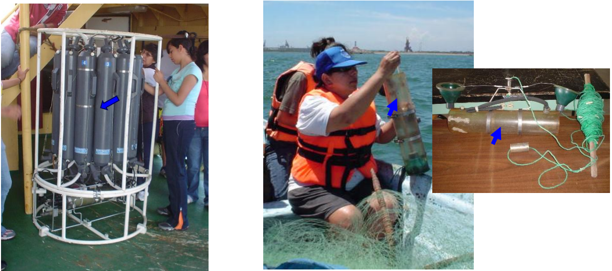
Figura 14. Botellas tomamuestras tipo Niskin izquierda y Van Dorn derecha.
