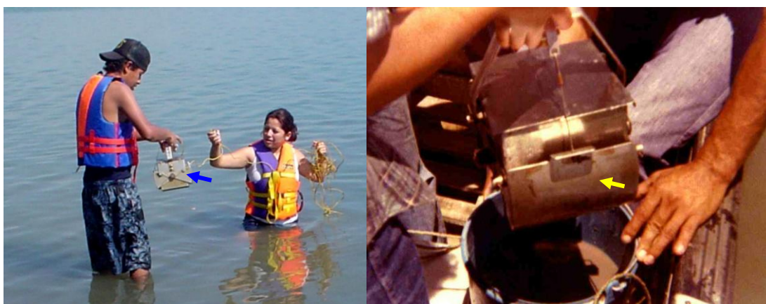
Figura 30. Obtención de sedimentos blandos de zonas menores a tres metros de profundidad por medio de una draga tipo Ekman.
