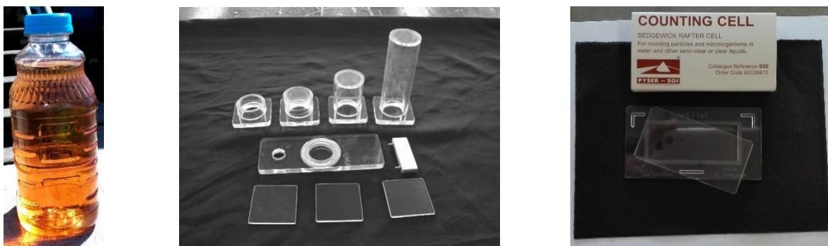
Figura 15. Izquierda muestra fijada con lugol, al centro cámaras cilíndricas tipo Kolwizt y a la derecha celda Sedgewick rafter.
