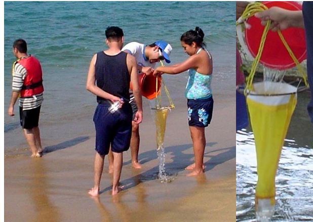
Figura 19. Muestreo estacionario, red cónica para arrastre con una longitud aproximada de 50 cm, aro mayor de 25 cm y una abertura de malla más o menos de 39 \mu m.
