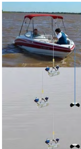
Figura 119. Muestreo para análisis cuantitativo de plancton mediante botella tipo Van Dorn, a diferentes profundidades de la columna de agua.
