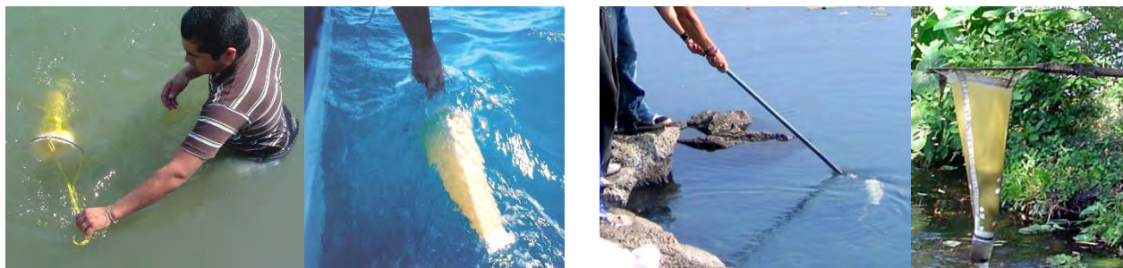
Figura 131. Muestreo por arrastre en sistemas someros, izquierda con red cónica de arrastre y derecha con red de cuchara.
