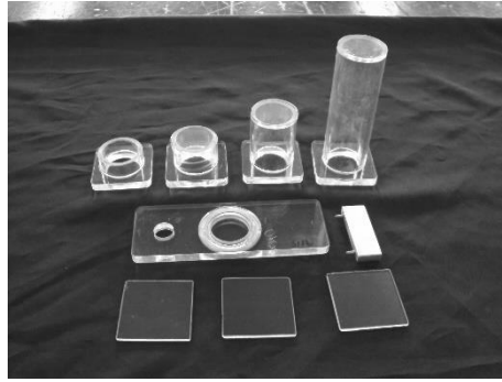
Figura 126. Izquierda muestra fijada con lugol, al centro cámaras cilíndricas tipo Kolwizt y a la derecha celda Sedgewick rafter.
