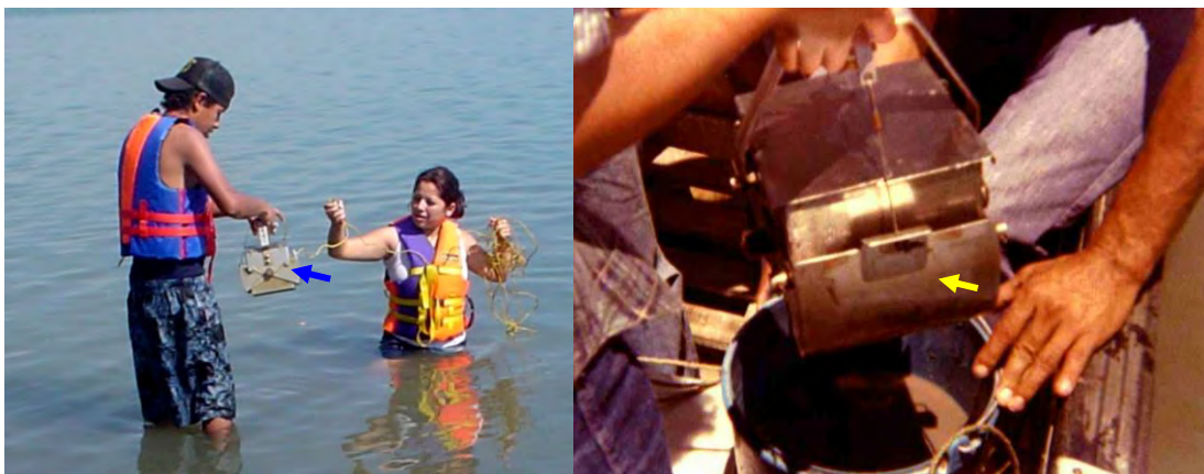
Figura 141. Obtención de sedimentos blandos de zonas menores a tres metros de profundidad por medio de una draga tipo Ekman.
