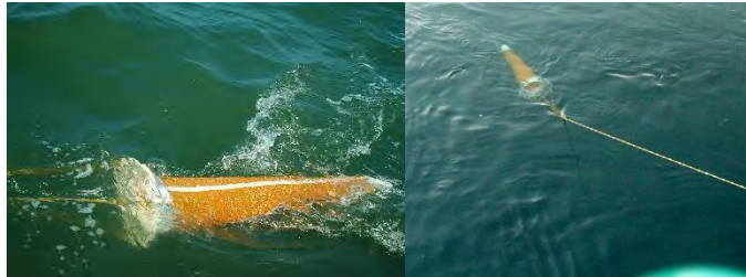
Figura 127. Redes de aro estándar para colecta horizontal, se muestra una red cónica con abertura de malla aproximadamente de 39.0 \mu\text{m} y una longitud de 150 cm, con un aro mayor de abertura de 50 cm de diámetro.
