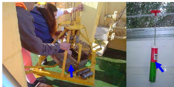
Figura 133. Colectores para protistas epipsámicos, izquierda draga Petersen y derecha nucleador cilíndrico.
