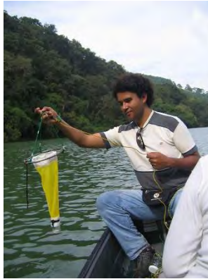
Figura 116. Muestreo de red para análisis cualitativo, colecta en la columna del agua de un cuerpo de agua profundo.
