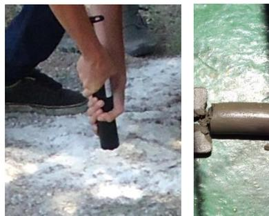
Figura 29. Izquierda obtención de núcleo, derecha barra de núcleo fresca.
