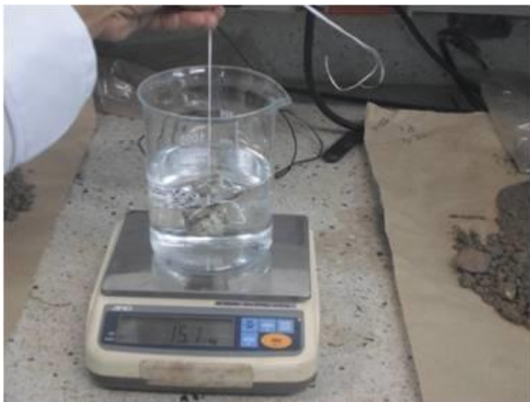
Figura 11. Peso del terrón con parafina en agua
