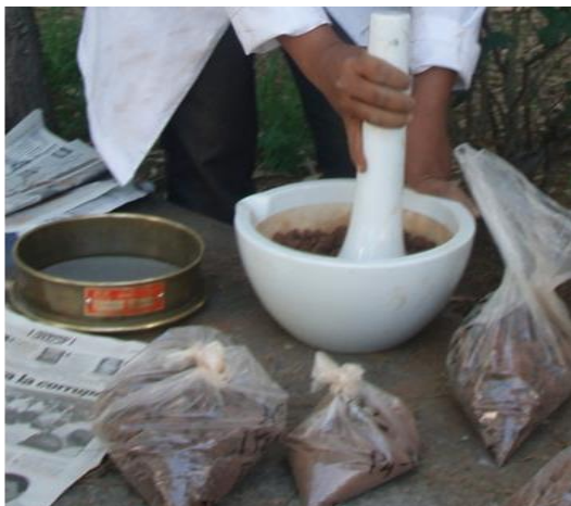
Figura 5. Molido, Tamizado y etiquetado de muestras de suelo.
