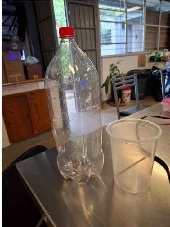
Figura 1. Envases para pluviómetro PET de 3 litros y vaso cilíndrico de un litro.
