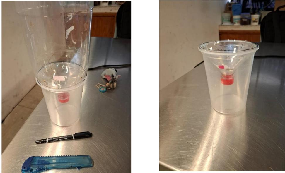
Figura 3. Recorte del embudo y su acomodo en el frasco.
