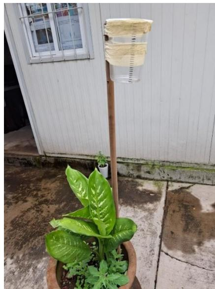
Figura 4. Pluviómetro montado en un bastón de madera.
