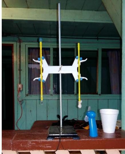
Figura 7. Psicrómetro rústico.
