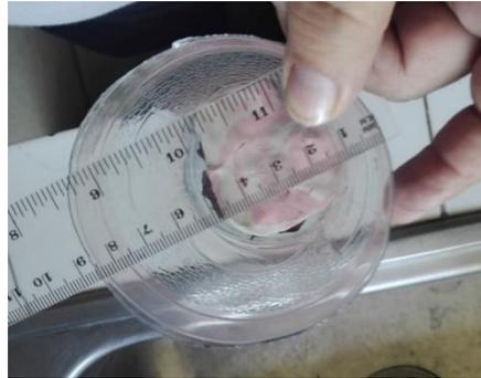
Figura 5. Diámetro de la boca del pluviómetro de campo.
