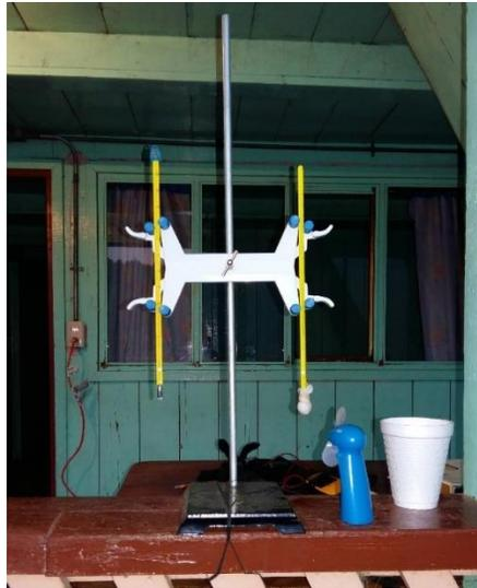
Figura 6. Psicrómetro rústico.
