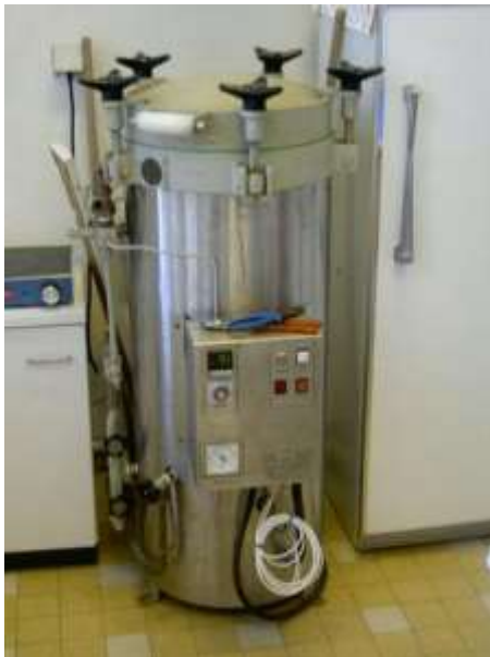
Figura 1. Una autoclave es un dispositivo que sirve para esterilizar el material de laboratorio, utilizando vapor de agua a alta presión y temperatura para ello. Por lo general, la utilización de una autoclave inactiva todos los virus y bacterias, aunque recientemente se ha llegado a saber de algunos microorganismos, así como los priones, que pueden soportar las temperaturas de autoclave.
