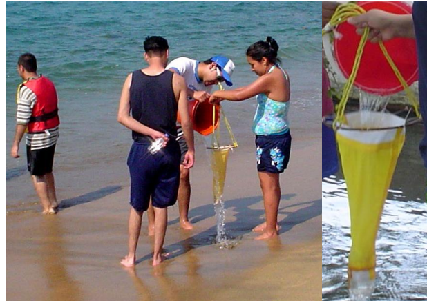
Figura 19. Muestreo estacionario, red cónica para arrastre con una longitud aproximada de 50 cm, aro mayor de 25 cm y una abertura de malla más o menos de 39 \mu\text{m} .
