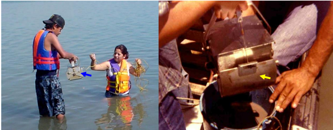
Figura 30. Obtención de sedimentos blandos de zonas menores a tres metros de profundidad por medio de una draga tipo Ekman.
