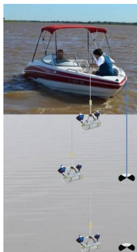
Figura 8. Muestreo para análisis cuantitativo de plancton mediante botella tipo Van Dorn, a diferentes profundidades de la columna de agua.
