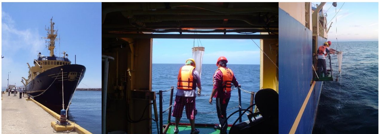
Figura 18. Muestreo de plancton marino por arrastre vertical en la provincia oceánica, a la izquierda se muestra el B/O El Puma de la UNAM y al centro y derecha el winche y la red cónica de arrastre.
