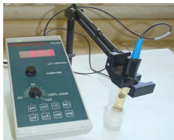
Figura 15. Potenciómetro.
