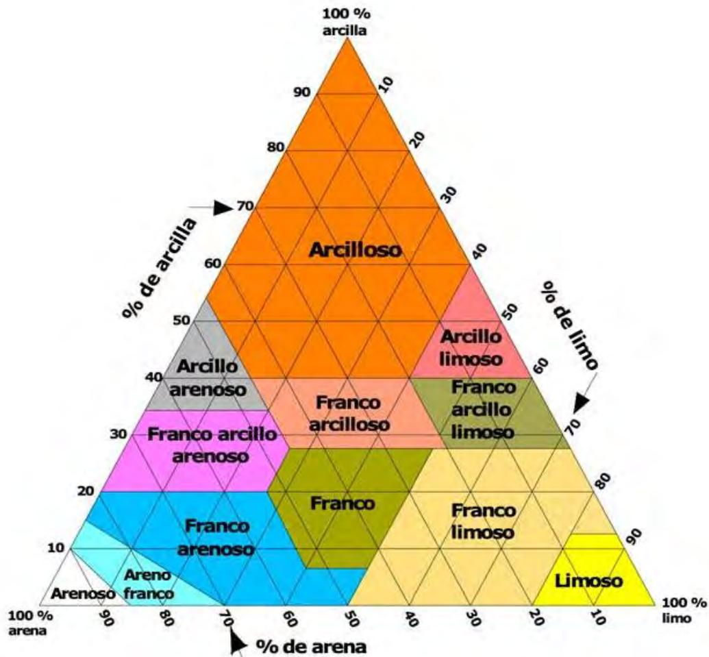
Figura 9. Triángulo para determinar la clase textural del suelo.
