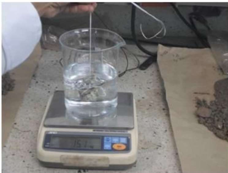
Figura 11. Peso del terrón con parafina en agua
