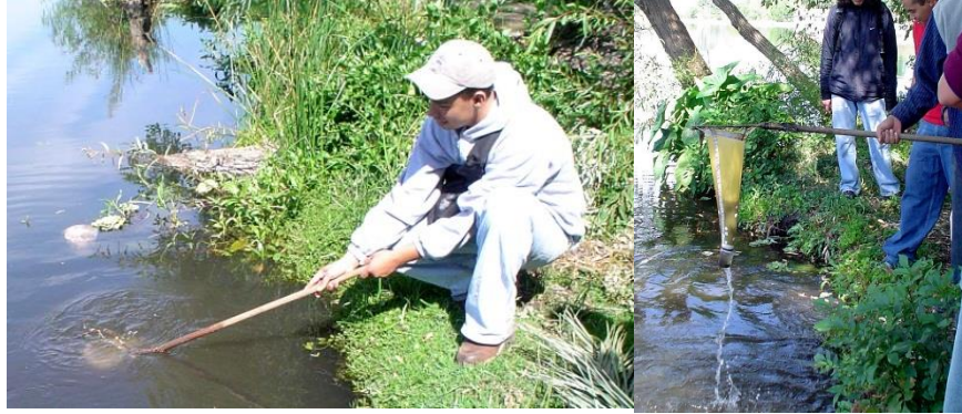
Figura 25. Muestreo de arrastre en “8” con red de cuchara para sistemas someros.
