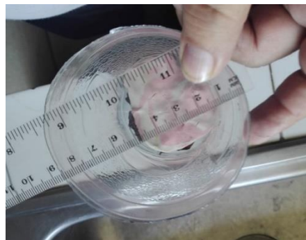
Figura 4. Diámetro de la boca del pluviómetro de campo.
