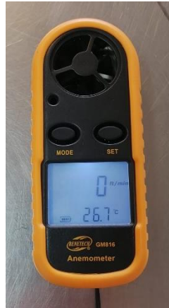
Figura 7. Anemómetro digital con veleta.
