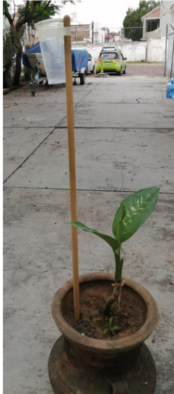
Figura 3. Pluviómetro montado en un bastón de madera.
